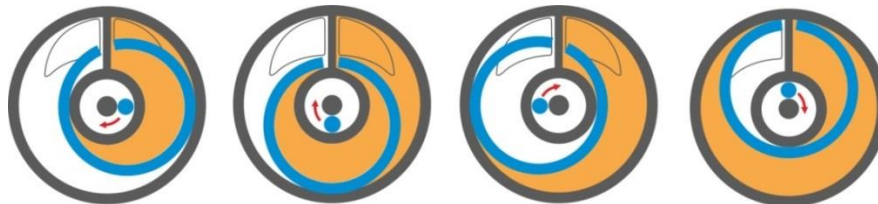
Рисунок 12 — Схема работы измерительной камеры DFM
